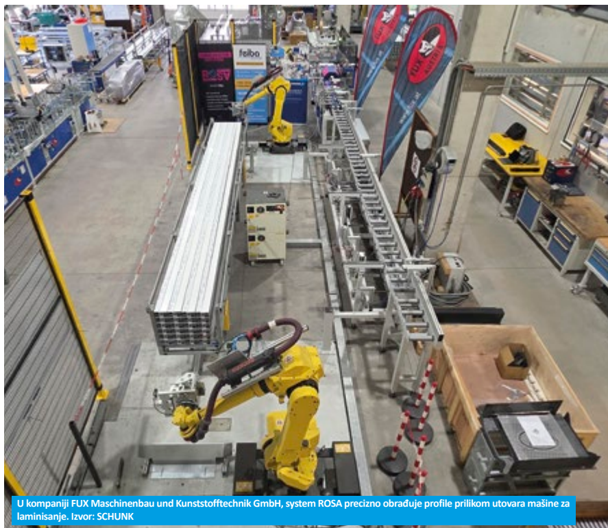
ROSA za vreme rada – profili od 6 metara, težine 9 kilograma, automatski i pouzdano se pomeraju pomoću patentiranog ROSA sistema za rukovanje. Izvor: SCHUNK
