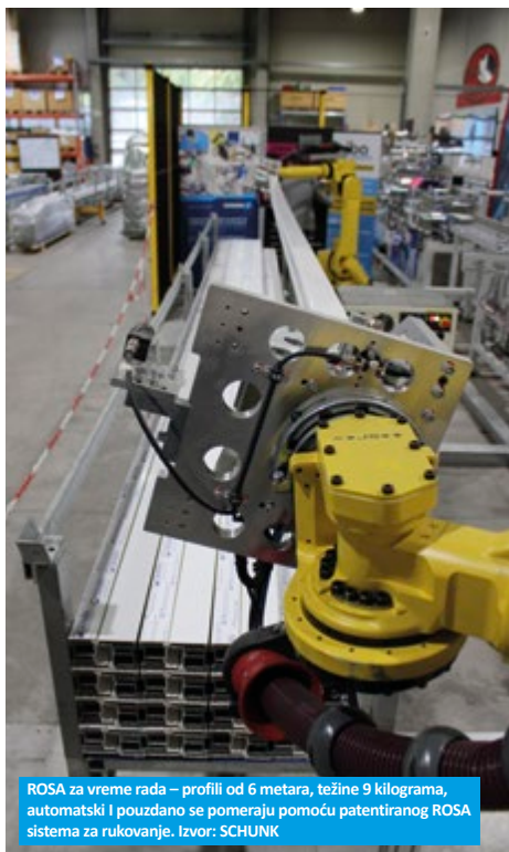
U kompaniji FUX Maschinenbau und Kunststofftechnik GmbH, system ROSA precizno obrađuje profile prilikom utovara mašine za laminisanje. Izvor: SCHUNK
