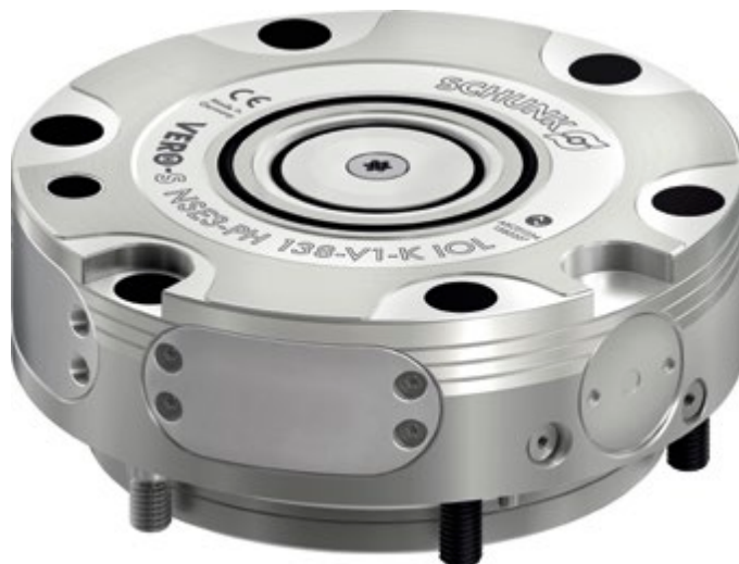
Električno pogonjeni moduli za brzu izmenu paleta sa potpuno integrisanom elektronikom i aktuatorima: zahvaljujući širokom spektru opcija nadzora i prenosa podataka, VERO-S NSE3-PH 138 IOL obezbeđuje veću transparentnost tokom procesa stezanja – bez ikakvih dodatnih smetajućih kontura. Izvor fotografije: SCHUNK SE & Co. KG
