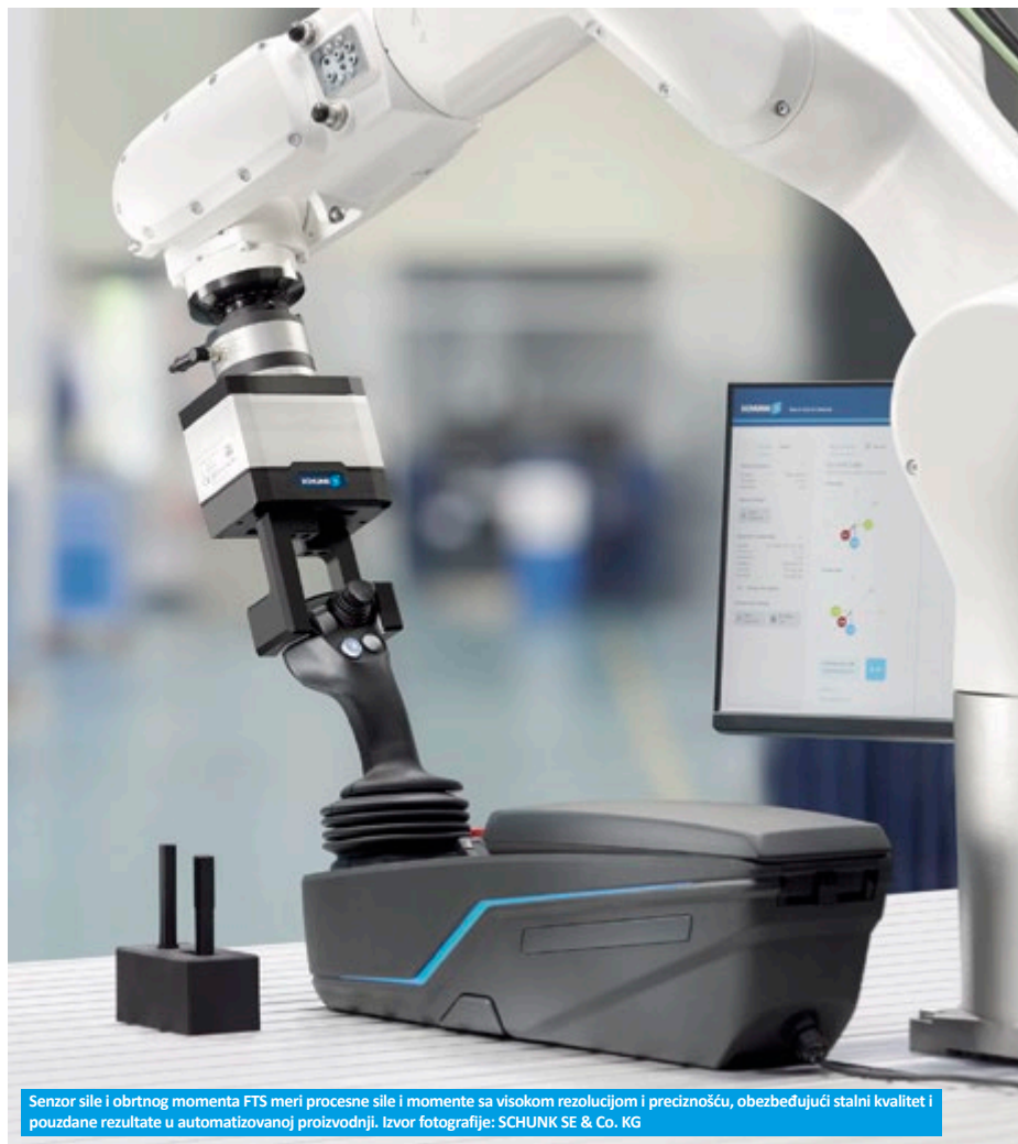
Kompanzaciona jedinica AGM nadoknađuje tolerancije, čime poboljšava stabilnost i efikasnost procesa. Ističe se velikom nosivošću, mogućnošću kompenzacije u više pravaca i širokim spektrom dostupnih varijanti. Izvor fotografije: SCHUNK SE & Co. KG
