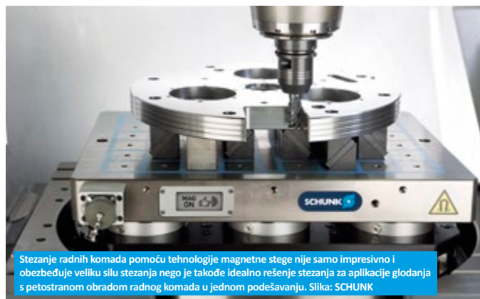
Kompanija SCHUNK je svoje proverene magnetne stegne MAGNOS MFRS opremila novim displejem statusa ePaper, koji jasno pokazuje stanje stezanja. Slika: SCHUNK
