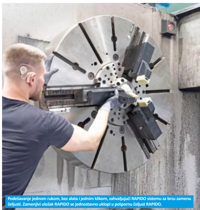
Mašina je podešena i radni komad velikog formata ergonomično je i bezbedno stegnut.
