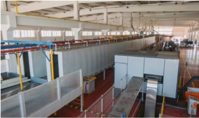
Linija za izradu panela za zaštitu od buke za puteve, integrisana u sistem za nadzor
