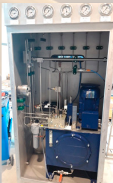
FECH - FASEK electro-central-hydraulic wellhead control system – upravljanje glavnim bušotinskim ventilima 10000 PSI; pouzdano, fleksibilno (napajanje hidrauličkog bloka), kompaktno, za visoki raspon temperature sve od -60 deg C
