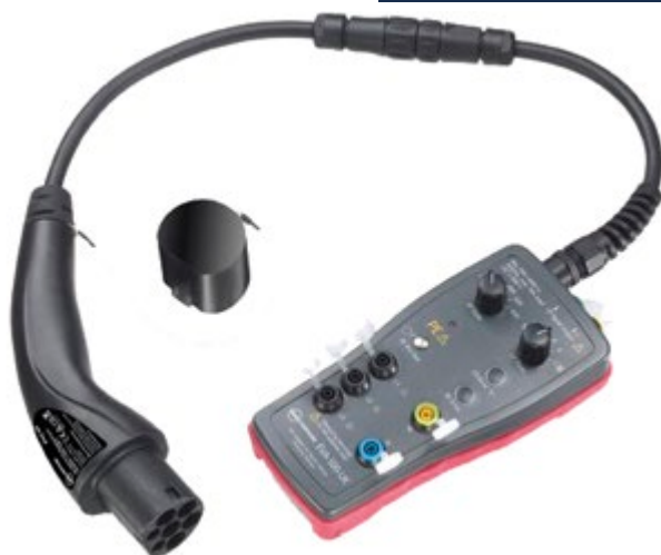
Adapter sa tip 1 priključkom je direktno povezan na punjač.
