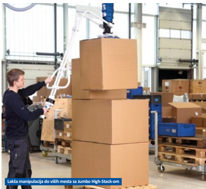
Jumbo Flex - ergonomski manipulator za bezbedno rukovanje teškim radnim predmetima
