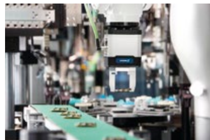
SCHUNK je razvio EGK hvatač za male komponente za rukovanje delikatnim radnim komadima koji su podložni oštećenju. On dokazuje svoju snagu pri izazovnim i raznovrsnim zadacima u laboratorijskoj industriji ili proizvodnji elektronike. SoftGrip režim hvatanja obezbeđuje rukovanje delovima u pouzdanom procesu.
