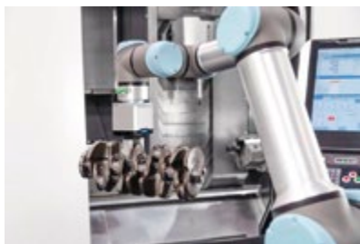
Pouzdanu rukovanje naročito teškim delovima, kao što su radilice, nije problem za EGU, koji akumulira više od ocenjene sile hvatanja zahvaljujući StrongGrip režimu.
