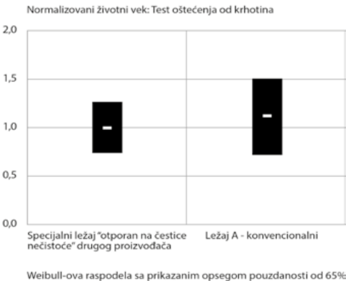
SLIKA 4 – UPOREĐIVANJE TESTOVA VEKA TRAJANJA LEŽAJA DOBIJENOG KONVENCIONALNIM PROCESOM I LEŽAJA "OTPORNOG NA ČESTICE NEČISTOĆE" DOBIJENOG POSEBNIM PROCESOM DRUGOG PROIZVOĐAČA, SPOLJNI PREČNIK LEŽAJA 68 mm.
