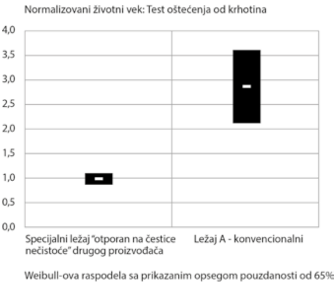
SLIKA 5 – UPOREĐIVANJE TESTOVA VEKA TRAJANJA LEŽAJA DOBIJENOG KONVENCIONALNIM PROCESOM I LEŽAJA "OTPORNOG NA ČESTICE NEČISTOĆE" DOBIJENOG POSEBNIM PROCESOM DRUGOG PROIZVOĐAČA, SPOLJNI PREČNIK LEŽAJA 318 mm.
