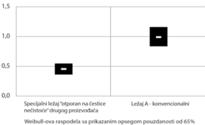
SLIKA 3 - UPOREĐIVANJE TESTOVA VEKA TRAJANJA LEŽAJA DOBIJENOG KONVENCIONALNIM PROCESOM I LEŽAJA "OTPORNOG NA ČESTICE NEČISTOĆE" DOBIJENOG POSEBNIM PROCESOM DRUGOG PROIZVOĐAČA, SPOLJNI PREČNIK LEŽAJA 83 mm.
