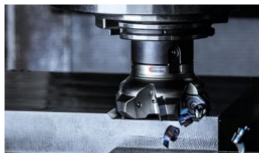
Čeona glodalica MaxiMill 273-08 sa dubinom sečenja do 5 mm i 16 reznih ivica na pločici je jedinstvena među čeonim glodalima i donosi korisnicima visoku efikasnost
