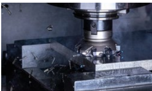
Čeona glodalica MaxiMill 273-08 sa dubinom sečenja do 5 mm i 16 reznih ivica na pločici je jedinstvena među čeonim glodalima i donosi korisnicima visoku efikasnost
