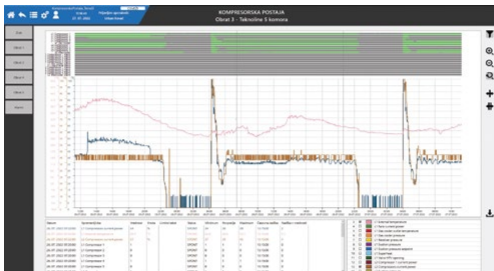
Trend dijagram glavnih parametara na R744 kompresorima za rashladu
