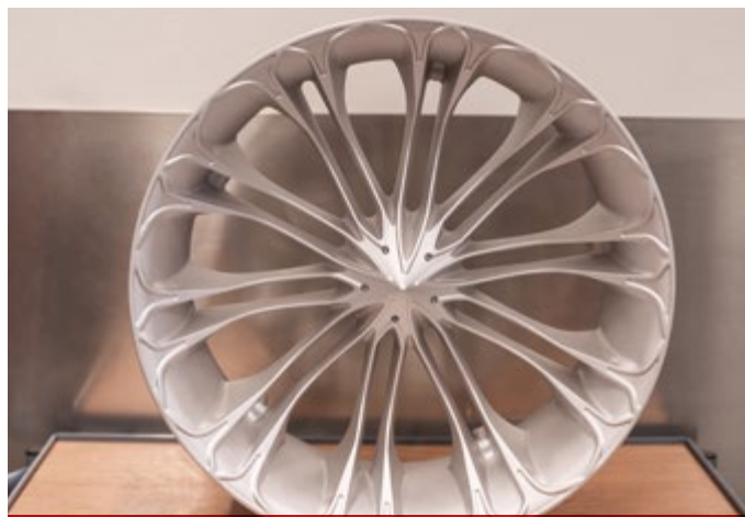
Međurezultat: Nakon peskiranja, monoblok felna je spremna za anodizaciju.
