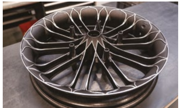
Na kraju, Thunderbike glodanjem obrađuje pojedinačne detalje na crnoj anodiziranoj felni, čime dodatno unapređuje dizajn.
