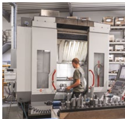
Julian Otten uklanja mašinski obrađeni poklopac kvačila iz mašine C 42 U MT.
