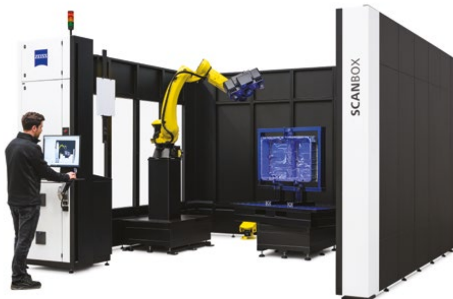
3D skeniranje i dimenzionalni pregled livenog kućišta za bateriju električnog automobila (Foto: Topomatika)
